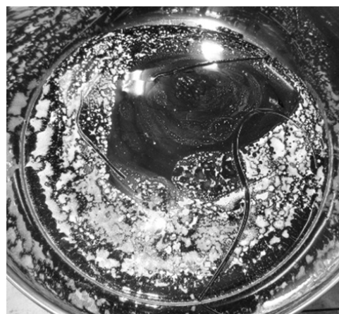
当所の熔融炉で作製したガラス固化体表面に析出したイエローフェーズ
