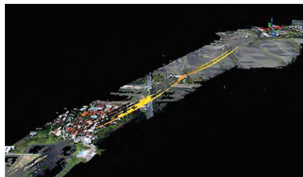
インドネシアでの適用例 (1 フライトで 2km 程の送電線を対象に点群を作製し、規定離隔モデルと離隔を計算)
