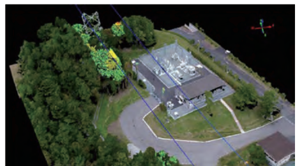
図 8 SfM 点群上に表示した離隔ヒートマップ
