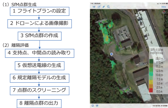
図9 離隔評価ワークフローと離隔点群生成ワークフロー(左)および離隔ヒートマップの表示例(右)
