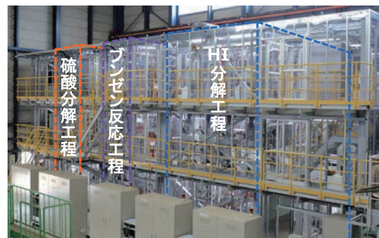
図4 連続水素製造試験装置
