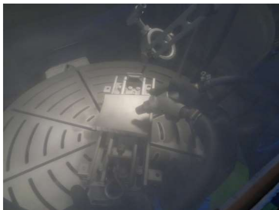
グローブボックス内でブラスト法による汚染の除去
