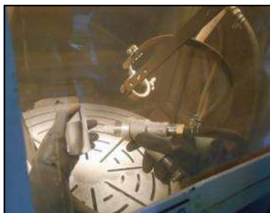
グローブボックス内でブラスト法による汚染の除去
