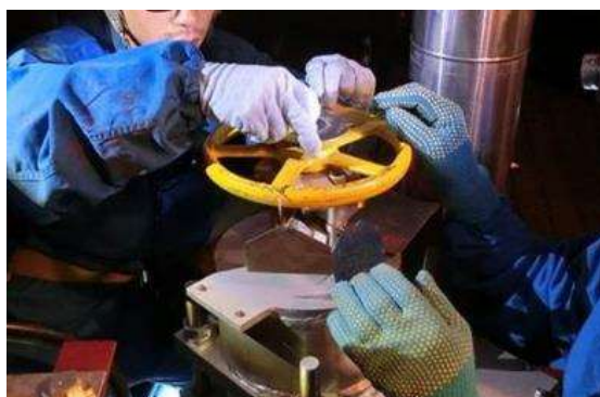
弁ハンドルの放射能測定（左：弁ハンドルの取外し 右：放射能測定）
