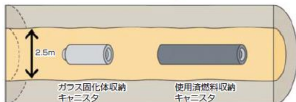
オパリナス粘土層内での高レベル放射性廃棄物の処分場とキャニスタの定置イメージ
