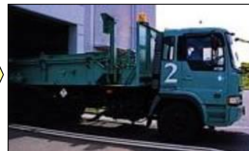
埋設地へ廃棄体を運搬
