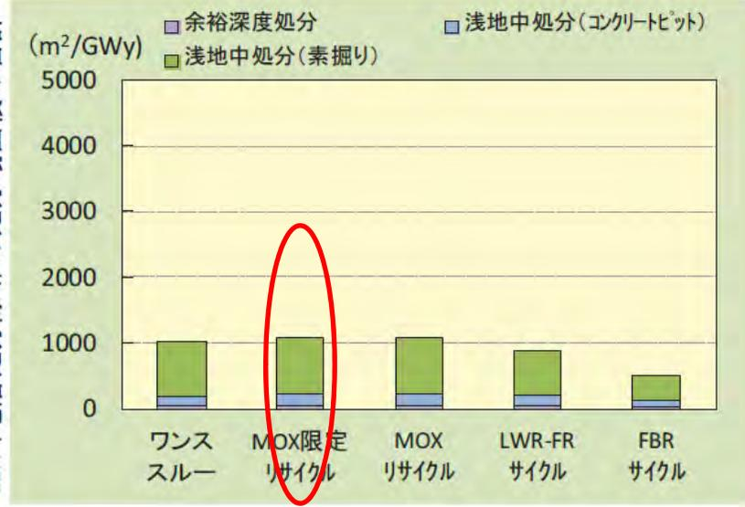
(注) 上記は硬岩竖置きの場合。前回の政策大綱の試算と同様に、使用済MOX燃料の直接処分に要する面積は、使用済ウラン燃料を直接処分する場合の4倍程度と想定。ガラス固化体の専有面積についても前回政策大綱と同様に想定。
