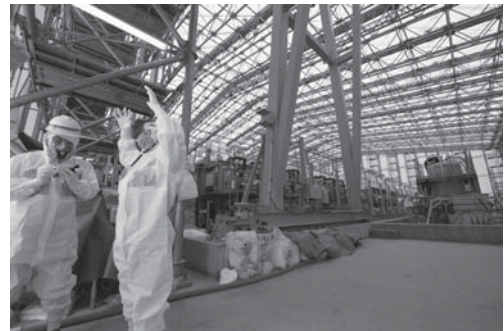
第3図 巨大な多核種除去装置「ALPS(アルプス)」 今回の取材で。(写真提供・Noriyuki Inoue / WEDGE)
