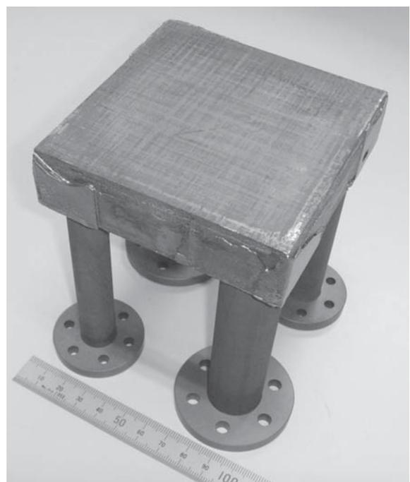
第 5 図 SiC 複合材料熱交換器スケールモデル
