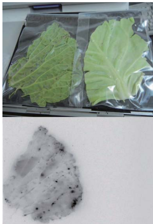
放射能で汚染されたキャベツ(左)と、ふつうのキャベツ(右)。下の写真は放射能画像解析システムにより、放射能汚染分布を画像化したもの。
