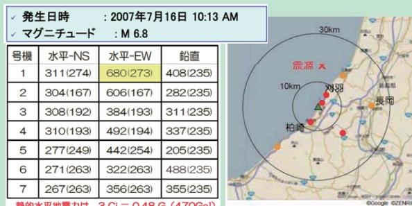
中越沖地震時に原子炉建屋基礎版上で観測された加速度単位: gal (cm/s<sup>2</sup>), カッコ内は設計時の最大加速度応答値
