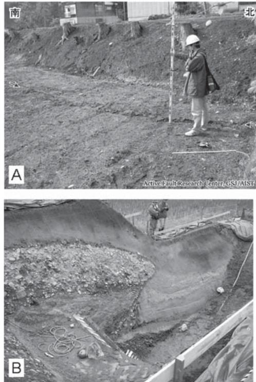
第10図 A:中越地震に伴って出現した地震断層と背後の崖 B:崖と地震断層を横断するトレンチに現れた逆断層
