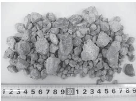
第2図 再生粗骨材の例
