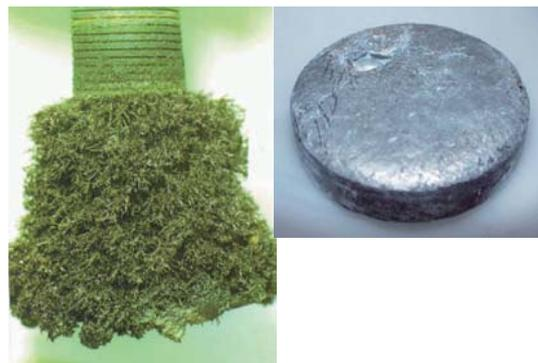
第4図 鉄陰極に析出した金属ウラン(左)とカドミウム陰極に回収したウラン-プルトニウム-MA合金(右)<sup>3)</sup>
