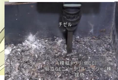
燃料デブリ切断技術の例 (チゼル)
