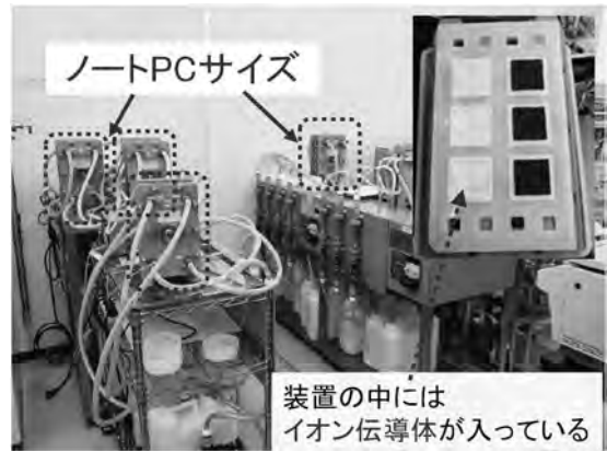
図9 イオン伝導体を装荷したリチウム回収試験装置
