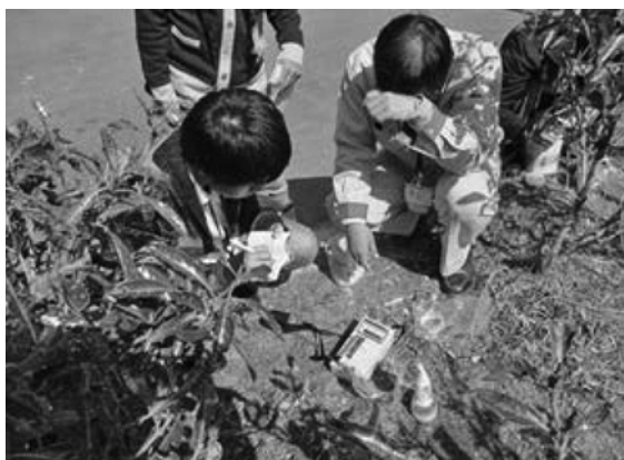
第3図 汚染土壌の線量測定風景
