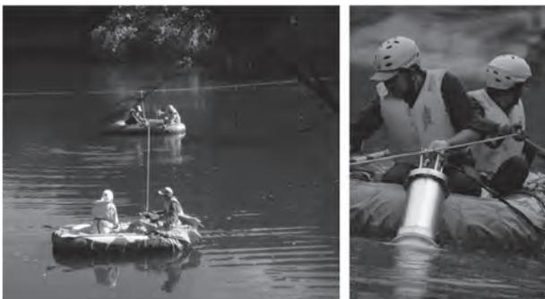
第5図 ため池測定風景(左:PSF,2つのボートの間にPSFが沈められている。右: $\gamma$ 線スペクトロメータ)
