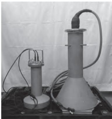
第9図 NaI シンチレーション検出器を用いた量産型のため池専用 $\gamma$ 線スペクトロメータ(日立アロカ社提供)
