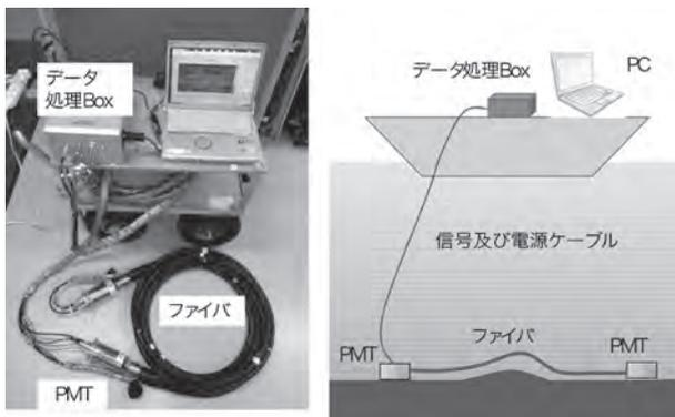
第1図 PSFシステム(JREC社製)の外観とため池底測定イメージ
