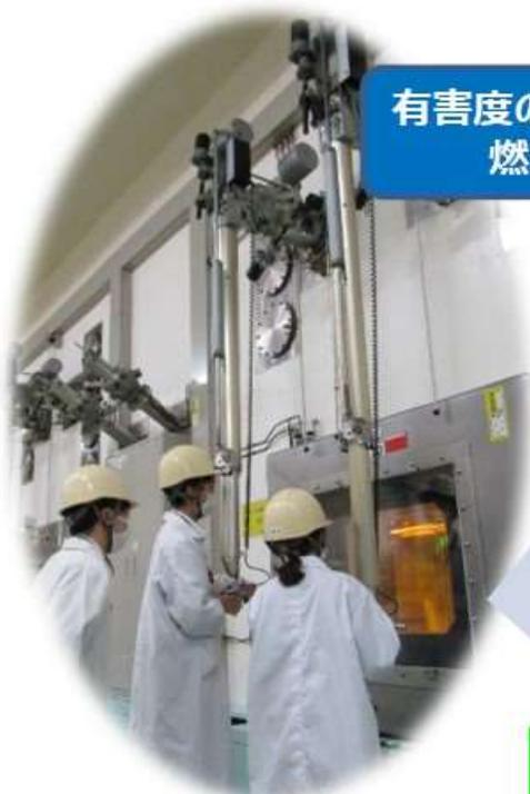
ホットセルでのMA含有燃料の遠隔製造 (大洗)
