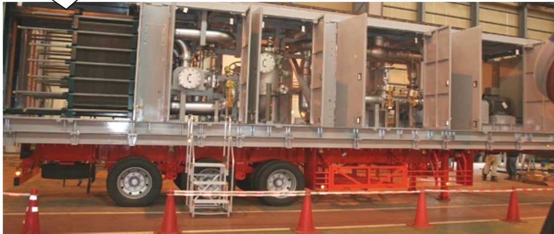
可搬式代替熱交換器設備 外観写真(例)
