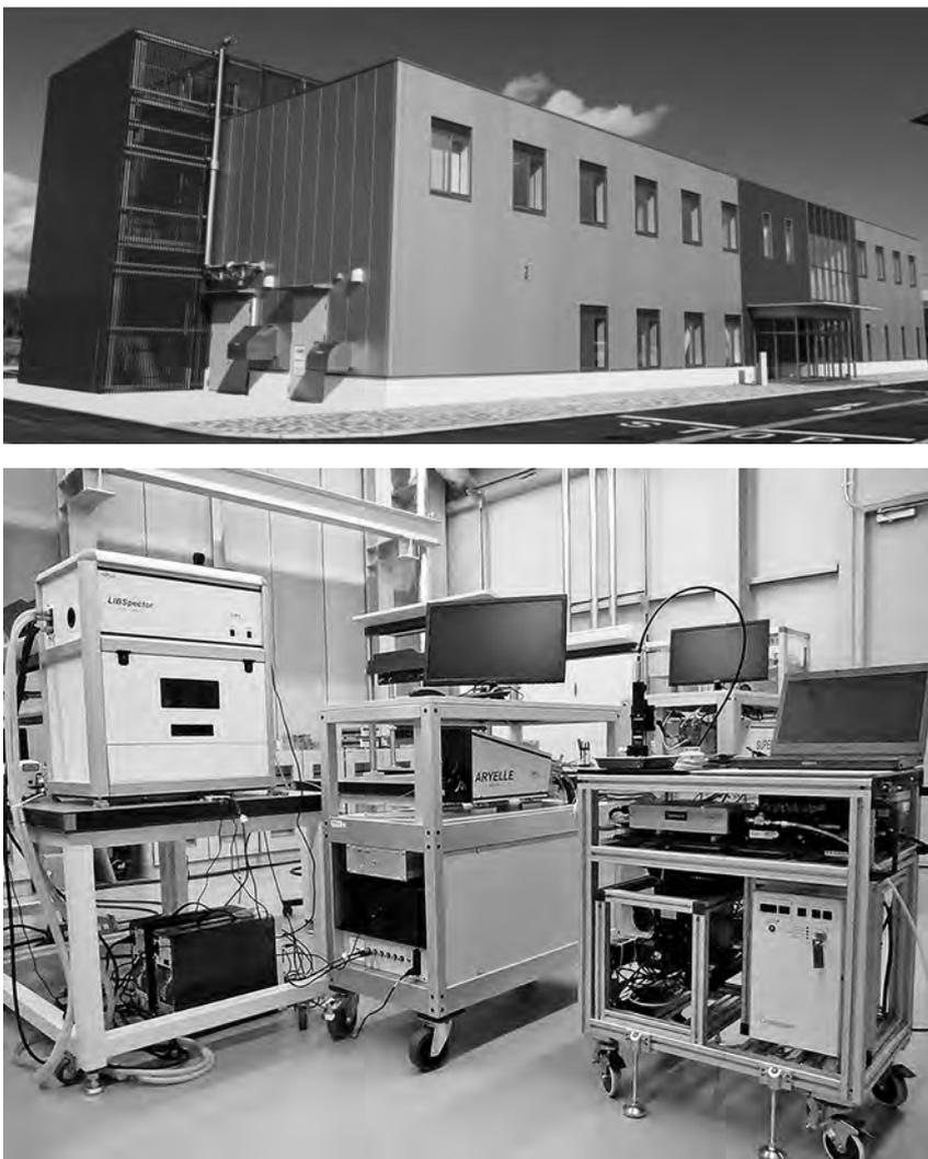
図4 上はCLADS国際共同研究棟、下は損傷した炉内にある燃料デブリなどの組成を調べるレーザー遠隔分析用基礎実験装置(左と中央)と開発した可搬型レーザー分析装置(右)
