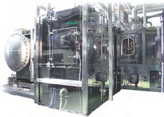
図3 EB滅菌方式無菌充填システム
