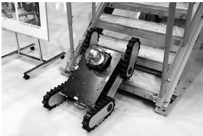
図3 ロボットによるモックアップ階段試験のようす
