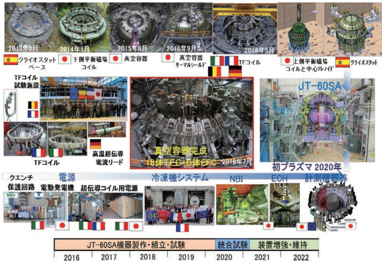
図8 JT-60SA トカマク本体組立の手順とその進捗
