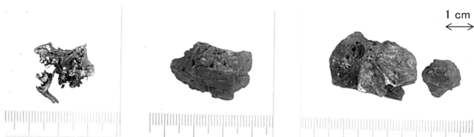
図4 TMI-2燃料デブリの例 (いずれも溶融プール形成領域から採取されたもの) (日本原子力研究開発機構より提供)
