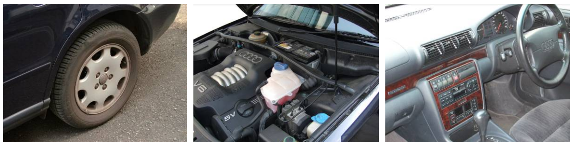
図 1：電子ビームを照射して作られた自動車用ゴム，プラスチック製品 (左) ラジアルタイヤ (中) エンジンルームの耐熱性電線 (右) フロントパネル
