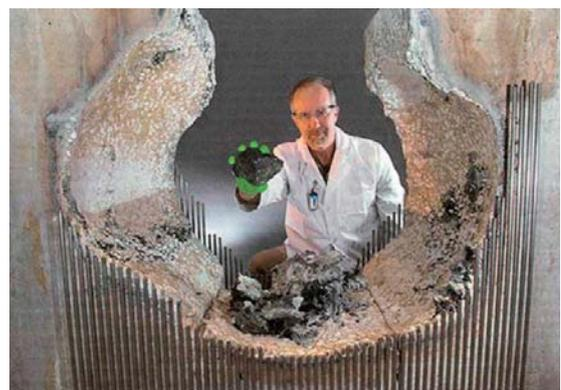
コリウム・コンクリート反応によるコンクリートの侵食実験のもよう (Argonne National Lab, USA)
