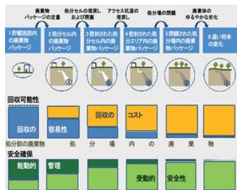
「R スケール」：地層処分場の状態変遷と廃棄物の状態、回収可能性/コストの程度、受動的/能動的の程度の変化を定性的に図示。(OECD/NEA R&R プロジェクトより引用)
