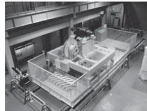
(a) 緩衝材定置試験設備の外観
