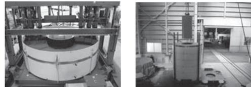
(a) 緩衝材原料の締め固め (b) PEMの組立
