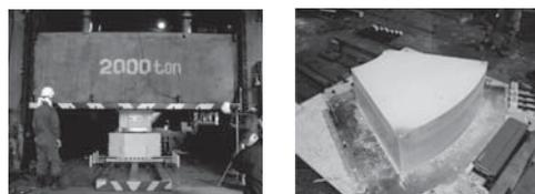
(a) プレス機による成形 (b) 成形したブロック
