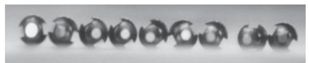
第3図 JMTR 炉心に挿入した溶融シリカ光ファイバ中を通過した白色光の出口出力の着色[左より、薄桃、青、水、薄桃、薄桃、薄桃、桃、桃、赤色へと変化](<http://www.imr.tohoku.ac.jp/ja/org/research/12.html>)
