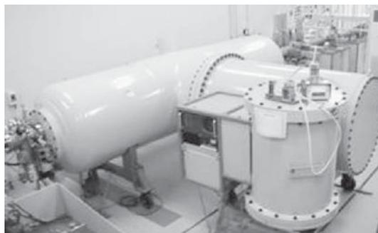
第5図 タンデム型静電加速器(HVVEE 社製)
