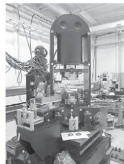
第1図 キュービック型マルチアンビルプレスを用いた高温高圧下 X 線回折実験の原理 (アンビルとプレスの写真を右に示す)
