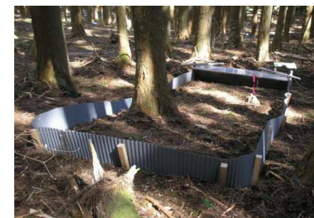
土砂流出量等を測定した試験斜面枠
