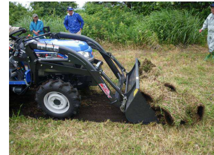
フロントローダーによる すくい上げ
