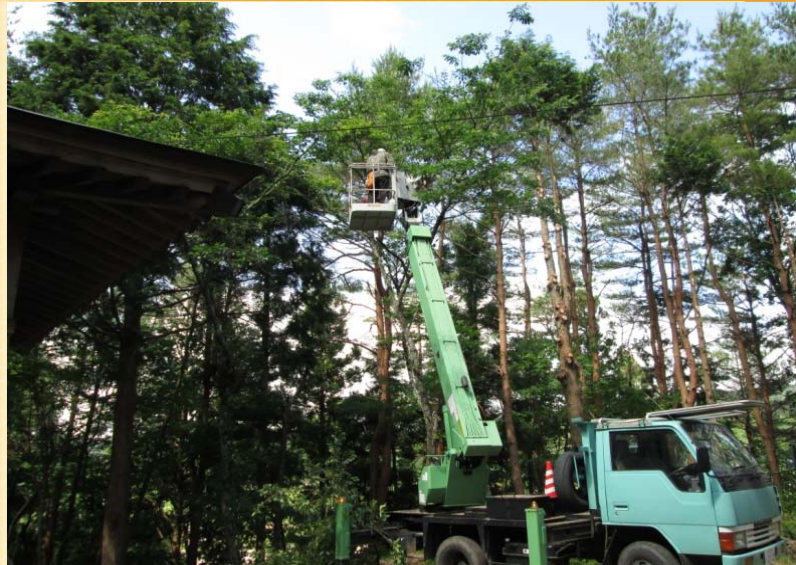
①高所作業車による枝打作業
