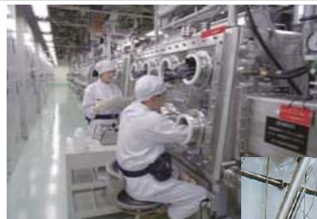
高い遮へい機能を 有する部屋（ホットセル） と遠隔操作 （マニピュレータ）の例
