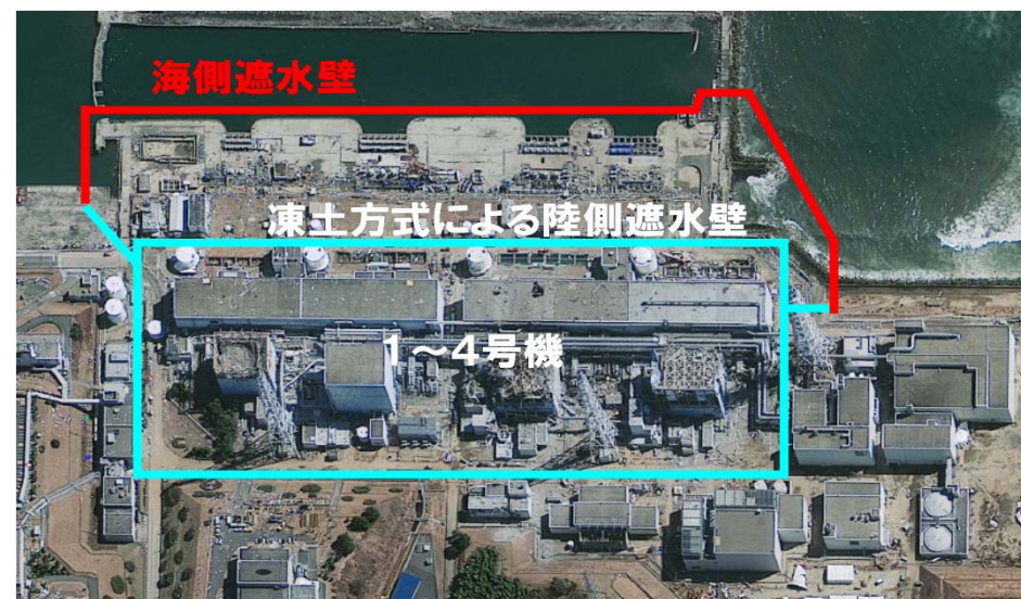
〔凍土による陸側遮水壁の配置案〕
