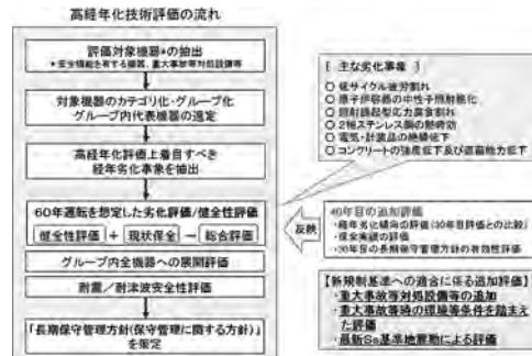
図3 高経年化技術評価フロー
