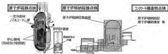
図2 特別点検の概要(PWRの例)
