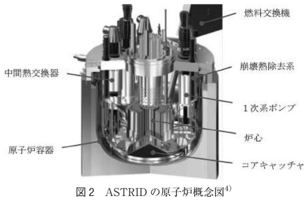
図2 ASTRIDの原子炉概念図<sup>4)</sup>
