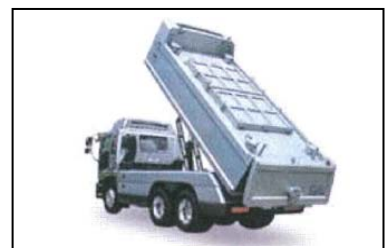
有蓋車(水密仕様ダンプ車の一例)
